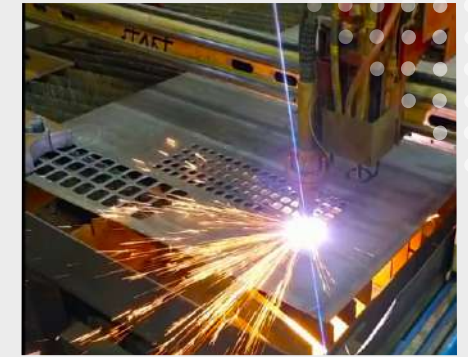
Раскройный цех, плазморез
